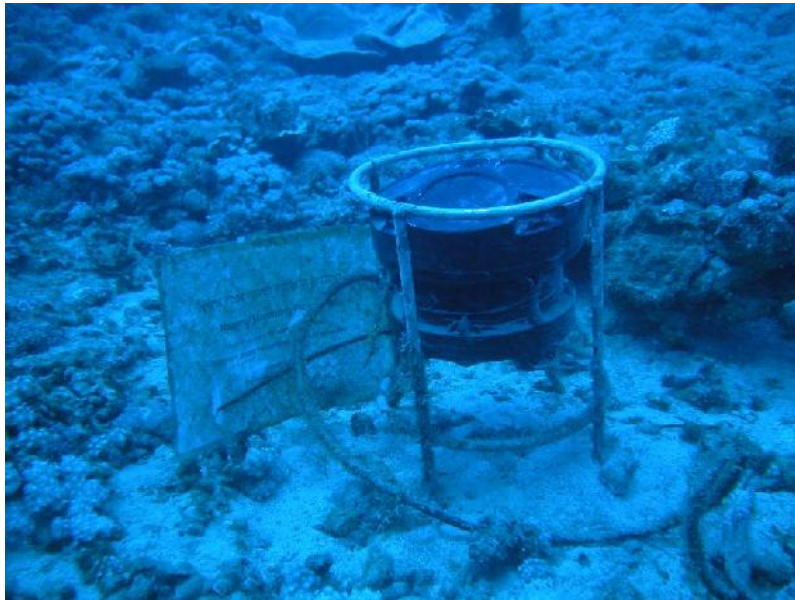
איור 11: מכשיר ה-ADCP על קרקעית הים בעומק 44 מ', מול הקצה הדרומי של המכון הבין-אוניברסיטאי. המכשיר מחובר בכבל תקשורת וחשמל ומזין נתונים ישירות לשרת המכון.
