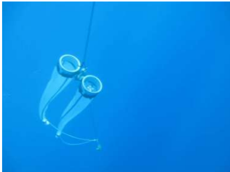
איור ד33: רשת הפלנקטון הכפולה ("Bongo") נגררת מהסירה בים העמוק. Figure D33: A double plankton net ("Bongo") towed from the boat in deep waters.
