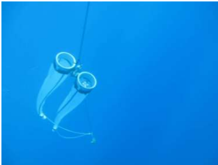
איור ד35: רשת הפלנקטון הכפולה ("Bongo") נגררת מהסירה בים העמוק. צילום: מ. צ'רניחובסקי Figure D35: A double plankton net ("Bongo") towed from the boat in deep waters. Photo: M. Chernihovsky
