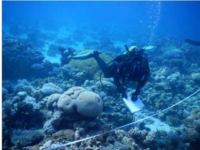
איור ב2: צוללות בעת סקר השונית בשמורת האלמוגים. סרט מדידה נפרש על השונית ועל הדף נרשם ההיטל של כל מה שנמצא תחת החתך ברמת דיוק של סנטימטר אחד. צילום: ניצן שגב. Figure B2: Divers during reef surveys at the nature reserve. A measuring tape is spread over the reef and the divers record the projected length of all the organisms and substrate underneath the line-transect to a resolution of 1 cm. Photo: N. Segev.
